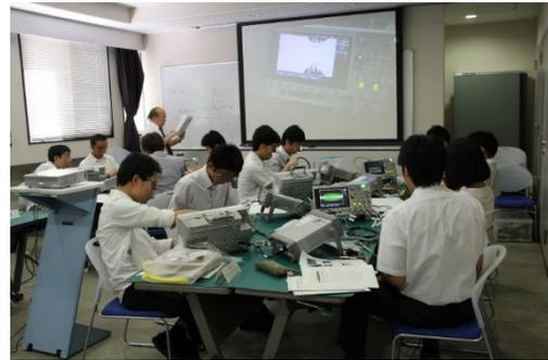
**注：**ここでの実験はオシロスコープを使って電磁界現象を観察します。また、実験においては準備している波形発生器の性能のために 30 MHz 以下の周波数帯域を対象にし、実験試料もそれに対応して工夫しています。
