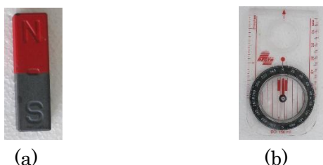
図 1.2 静磁界の例：磁石(a)と方位磁針(b)
