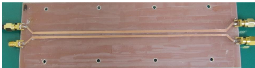
図 6.1 伝送線路に近接する他の伝送線路（図は近接線路の左端が開放、右端が短絡されたモデル）
