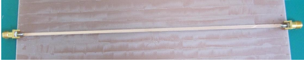
図 5.6 測定対象とするマイクロストリップ線路（長さ 200 mm、線幅約 2 mm）
