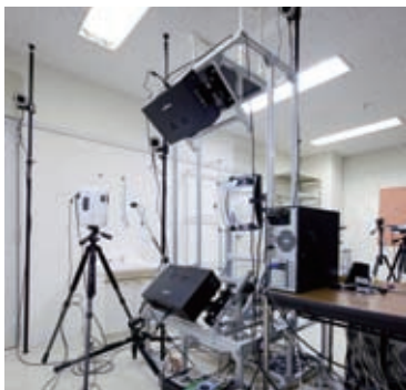
凸面鏡を使った広視野投影装置
