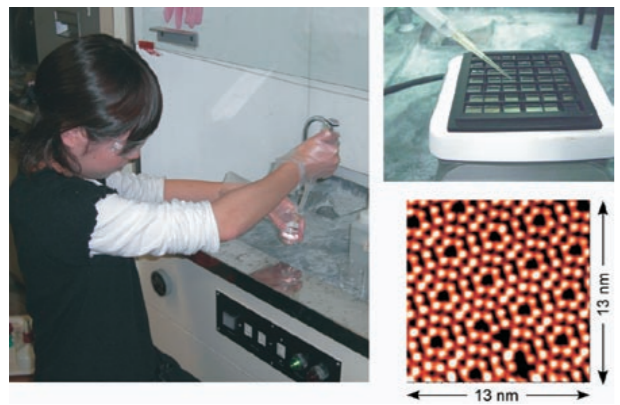
シリコン微粒子の基板上堆積と清浄Si表面のSTM像
