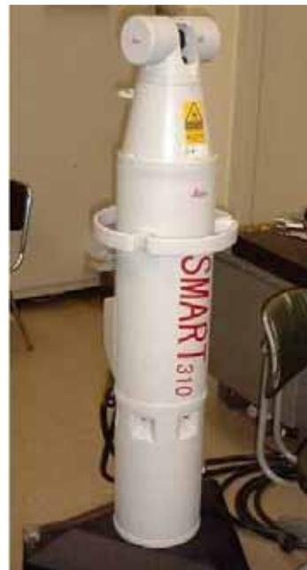
三次元レーザー干渉計測システム
