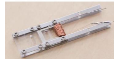
功率传感器节点的坡莫合金磁头
