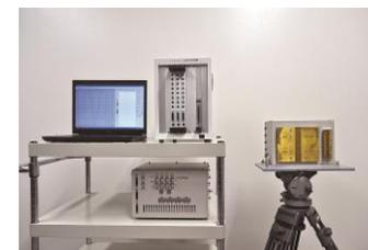
多频步进 CPC 毫米波雷达
