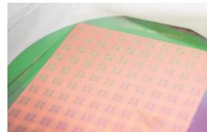
制作中观元件使用的将金电极制成布线图案的硅基板
