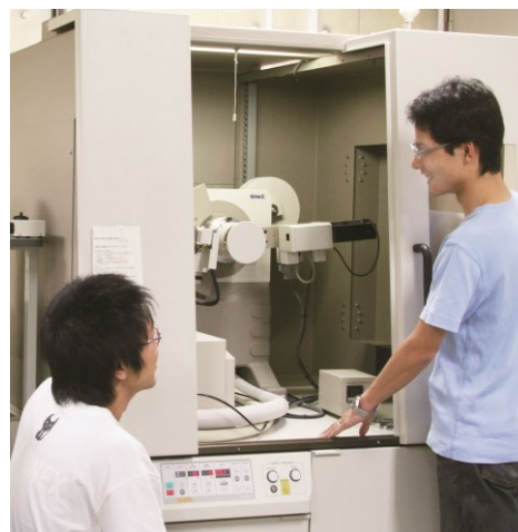
粉末 X 射线衍射仪（差示扫描量热同步测定）
