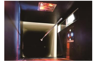
风洞磁悬浮平衡系统内部
