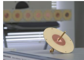
MIMO 天线 (利用 3 重偏波的超小型天线)
