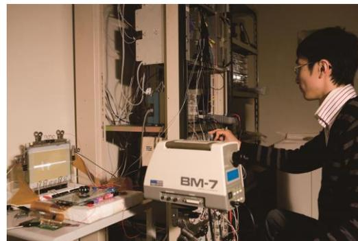
小型测试 PDP 的辉度测量
