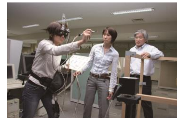
采用 3D 草图的与实物大小一样且可操作的 3D 设计辅助系统
