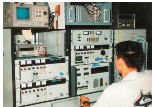
短波电离层干扰观测用发射台 JG2XA (以铷原子振荡器为基准)
