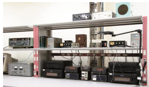
短波电离层干扰观测用发射台 JG2XA (以铷原子振荡器为基准)
