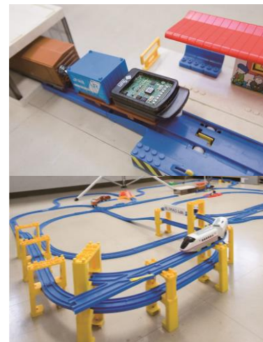
将 RFID 安装在玩具火车上来测量电车的动作
