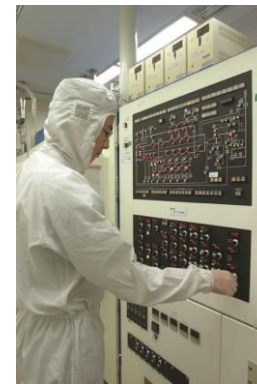
制造化合物半导体器件使用的 MOCVD (有机金属气相外延) 装置
