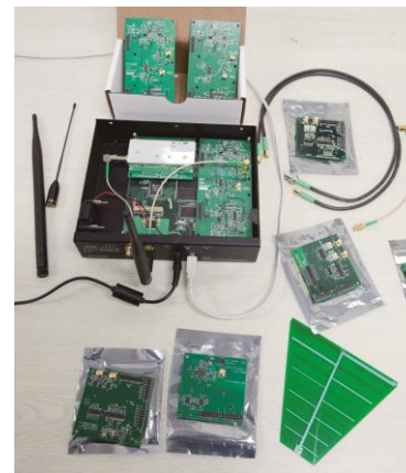
用于认知无线电实验的无线电路板
