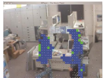
加工并显示从 MPEG2 中提取的物体信息直接运用 MPEG2 研究物体跟踪—适用于计算量较少的实时处理, 可跟踪多个物体
