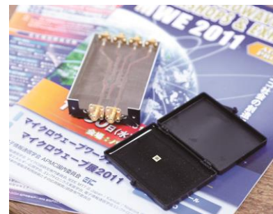
试制 6 端口相关器 (基本类型与 MMIC 类型)
