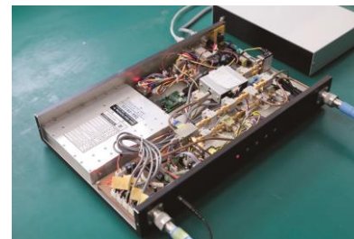
使用 6 端口相关器技术的试制 X 带 VNA
