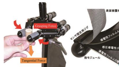
通过滑动检测，控制机械手的把持力
