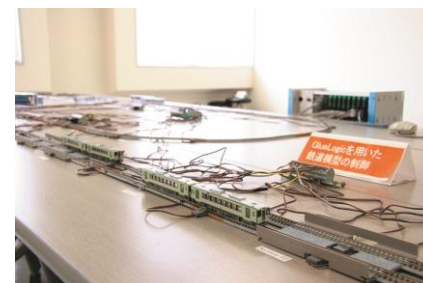
采用 Glue Logic 铁路模型控制演示系统。可使多辆列车自由行驶, 避免冲撞及追尾。控制回路由该研究室自己制作, 车辆和线路是市场上销售的商品。
