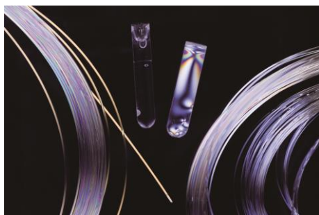
在两个直交的线圈之间观察到的高分子状态。很明显能看到具有各向异性的部分。中间左侧是消除双折射的高分子。中间右侧是普通的高分子。左右是聚合物光纤。
