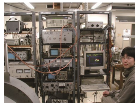
NMR 测量系统: 由检测 10MHz 的高次谐波振荡器信号的锁定放大器、数字伏特计、观测波形的示波器等构成。计算机显示屏上的黄色线表示质子的 NMR 信号
