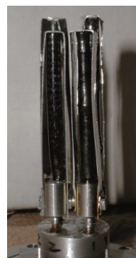
用于中子散乱实验的 LaCoO 3 试验样品。使红外线集中加热炉制作的 4 条单结晶的方向一致
