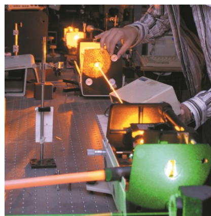
皮秒激光系统(cw-Mode-Lock YAG)。绿色光(532nm)与橙色光(590nm)的脉冲幅度分别约为 100 皮秒和 10 皮秒
