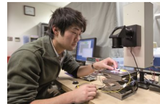
图 3 测量太阳能电池的光电转换特性
