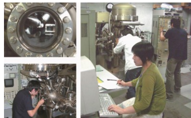
用光电子分光(XPS)装置分析样品
