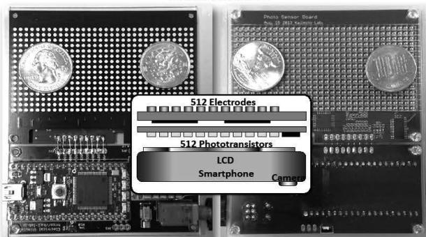
基本となるシステムはスマートフォン、 $32 \times 16$ 点の光センサおよび電気触覚ディスプレイから構成されます。スマートフォンは画像を取得、処理し、結果をLCDに表示します。この白黒画像が光センサによって取得され、電気触覚ディスプレイによってダイレクトに触覚パターンに変換されます。システム全体はバッテリー駆動で3時間程度連続使用が可能です。
