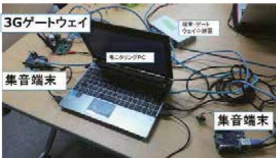
図2: 音源推定システムの外観
